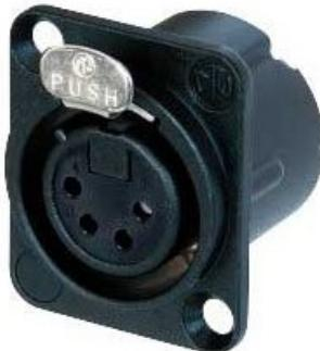
Presa femmina a 4 poli, con terminali a saldare, alloggiamento in metallo nero, contatti argentati. La serie DLX è caratterizzata da un alloggiamento metallico compatto con un ingegnoso contatto di terra duplex, che offre un'eccellente schermatura e protezione RF.
