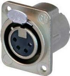
Presa femmina a 4 poli, con terminali a saldare, alloggiamento nichelato, contatti argentati, fori di montaggio M3. La serie DLX presenta un alloggiamento metallico compatto con un ingegnoso contatto di terra duplex, che offre un'eccellente schermatura e protezione RF.
