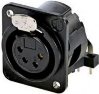
Presa femmina a 4 poli, montaggio orizzontale su scheda, alloggiamento nero, contatti placcati in oro, fori di montaggio M3. Presenta un alloggiamento metallico compatto con un ingegnoso contatto di terra duplex che offre un'eccellente schermatura e protezione RF.
