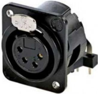
Connettore femmina a 4 pin, montaggio orizzontale su scheda, alloggiamento nero, contatti argentati, fori di montaggio M3. Presenta un alloggiamento metallico compatto con un ingegnoso doppio contatto di terra, che offre un'eccellente schermatura e protezione RF. L'inserto NON è rimovibile dall'alloggiamento.
