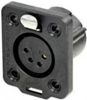
Connettore a telaio femmina a 4 poli, VERA PROTEZIONE ESTERNA (TOP) La serie X-TOP è un connettore a telaio XLR robusto per uso esterno. È protetto dall'esterno grazie all'accoppiamento con il relativo connettore per cavi della gamma XLR TOP (IP65 e UL50E). I contatti placcati in oro sono standard.
