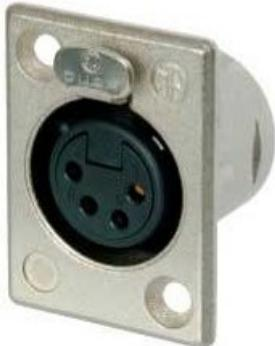
Presa femmina a 4 poli, contatti a saldare, alloggiamento in nichel, contatti argentati. Il più piccolo connettore per montaggio a pannello di tipo tradizionale disponibile sul mercato, con ampie coppe di saldatura per facilitare il cablaggio.
