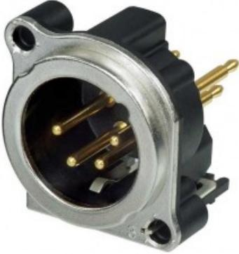
Presa XLR maschio a 4 poli, messa a terra: contatto di terra separato per l'alloggiamento del connettore e il pannello frontale, montaggio verticale su scheda. Come la Serie A, con l'eccezione di una flangia di montaggio in metallo che presenta un contatto di terra circonferenziale continuo con lo chassis per una migliore pratica EMC.
