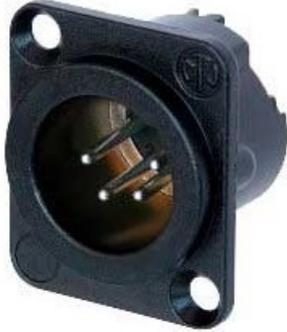
Presca maschio a 4 poli, con terminali a saldare, alloggiamento in metallo nero, contatti argentati. La serie DLX è caratterizzata da un alloggiamento metallico compatto con un ingegnoso contatto di terra duplex, che offre un'eccellente schermatura e protezione RF.
