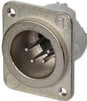
Presa maschio a 4 poli, con tappi a saldare, alloggiamento in nichel, contatti in argento, fori di montaggio M3. La serie DLX presenta un alloggiamento metallico compatto con un ingegnoso contatto di terra duplex, che offre un'eccellente schermatura e protezione RF.
