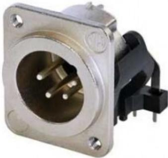
Presa maschio a 4 poli, montaggio orizzontale su scheda, alloggiamento in nichel, contatti argentati, fori di montaggio M3. Presenta un alloggiamento compatto interamente in metallo con un ingegnoso contatto di terra duplex, che offre un'eccellente schermatura e protezione dalle RF.
