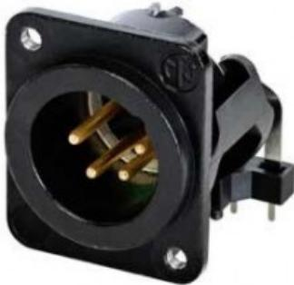
Connettore maschio a 4 pin, montaggio orizzontale su scheda, alloggiamento nero, contatti placcati in oro, fori di montaggio M3. Presenta un alloggiamento compatto interamente in metallo con un ingegnoso contatto di terra duplex, che offre un'eccellente schermatura e protezione RF. L'inserto NON è rimovibile dall'alloggiamento.
