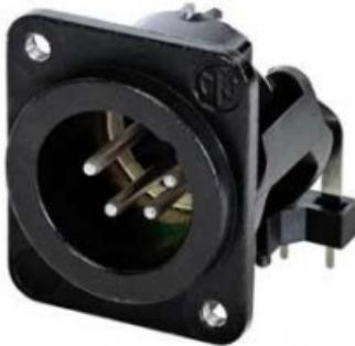
Presa maschio a 4 poli, montaggio orizzontale su scheda, alloggiamento nero, contatti argentati, fori di montaggio M3. Presenta un alloggiamento metallico compatto con un ingegnoso contatto di terra duplex, che offre un'eccellente schermatura e protezione RF. L'inserto NON è rimovibile dall'alloggiamento.
