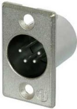
Presa maschio a 4 poli, contatti a saldare, alloggiamento in nichel, contatti argentati. Il più piccolo connettore per montaggio a pannello di tipo tradizionale disponibile sul mercato, con ampie coppe di saldatura per facilitare il cablaggio.
