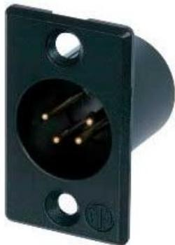
Presa maschio a 4 poli, contatti a saldare, alloggiamento in metallo nero, contatti placcati oro. Il più piccolo connettore per montaggio a pannello di tipo tradizionale disponibile sul mercato, con ampie coppe di saldatura per facilitare il cablaggio.
