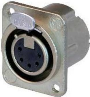
Presa femmina a 5 pin, con terminali a saldare, alloggiamento in nichel, contatti in argento, fori di montaggio M3. La serie DLX presenta un alloggiamento metallico compatto con un ingegnoso contatto di terra duplex, che offre un'eccellente schermatura e protezione RF.
