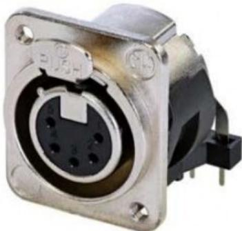
Connettore femmina a 5 pin, montaggio orizzontale su scheda, alloggiamento in nichel, contatti argentati, fori di montaggio M3. Presenta un alloggiamento metallico compatto con un ingegnoso contatto di terra duplex, che offre un'eccellente schermatura e protezione RF. L'inserto NON è rimovibile dall'alloggiamento.
