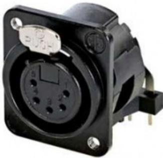
Connettore femmina a 5 poli, montaggio orizzontale su scheda, alloggiamento nero, contatti argentati, fori di montaggio M3. Presenta un alloggiamento metallico compatto con un ingegnoso contatto di terra duplex, che offre un'eccellente schermatura e protezione RF. L'inserto NON è rimovibile dall'alloggiamento.
