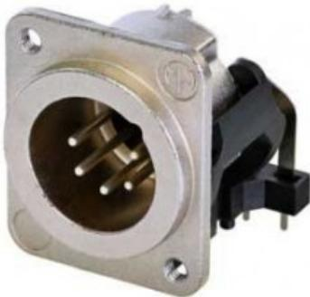
Presa maschio a 5 pin, montaggio orizzontale su scheda, alloggiamento in nichel, contatti argentati, fori di montaggio M3. Presenta un alloggiamento compatto interamente in metallo con un ingegnoso contatto di terra duplex, che offre un'eccellente schermatura e protezione RF. L'inserto NON è rimovibile dall'alloggiamento.
