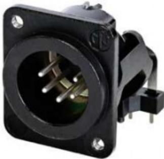
Presa maschio a 5 pin, montaggio orizzontale su scheda, alloggiamento nero, contatti argentati, fori di montaggio M3. Presenta un alloggiamento metallico compatto con un ingegnoso contatto di terra duplex, che offre un'eccellente schermatura e protezione RF. L'inserto NON è rimovibile dall'alloggiamento.
