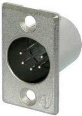
Connettore per montaggio a pannello di tipo tradizionale con presa maschio a 5 pin, contatti a saldare, alloggiamento in nichel e contatti argentati. Il connettore più piccolo disponibile sul mercato è dotato di ampi spazi per la saldatura per facilitare il cablaggio diretto.
