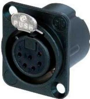
Presa femmina a 6 poli, terminali a saldare, alloggiamento in metallo nero, contatti placcati in oro. La serie DLX presenta un alloggiamento compatto interamente in metallo con un ingegnoso contatto di terra duplex, che offre un'eccellente protezione e schermatura contro le interferenze RF.
