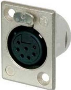
Presa femmina a 7 pin, contatti a saldare, alloggiamento in nichel, contatti argentati. Il più piccolo connettore per montaggio a pannello di tipo tradizionale disponibile sul mercato, con ampie coppe di saldatura per facilitare il cablaggio.
