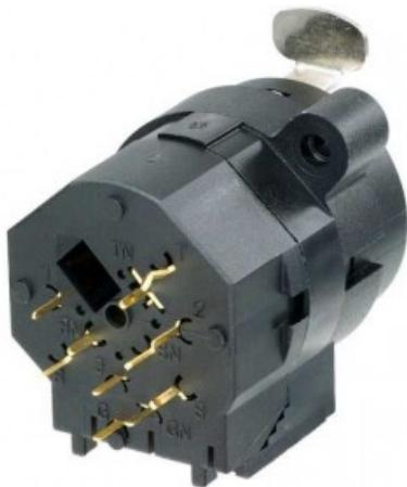
Presa XLR femmina a 3 poli con connettore stereo con interruttore da 1/4 e contatto di massa dell'interruttore, montaggio verticale su PCB. Connettore ibrido XLR/jack per chassis che combina una presa XLR a 3 poli e un jack da 1/4 .
