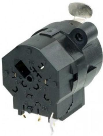
Presa XLR femmina a 3 poli con connettore mono da 1/4 senza contatto di commutazione, montaggio orizzontale su PCB. Connnettore ibrido XLR/jack per chassis che combina una presa XLR a 3 poli e un jack da 1/4 .
