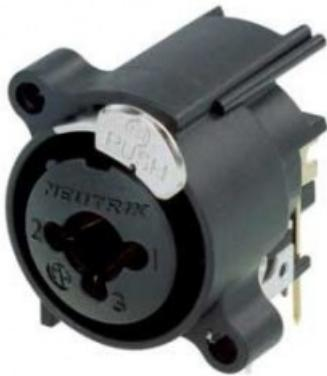
Connettore ibrido XLR a 3 poli femmina con jack stereo da 1/4 , montaggio orizzontale su scheda, push-on asimmetrico. Connettore ibrido XLR/jack a telaio che combina una presa XLR a 3 poli e un jack da 1/4 nel più piccolo alloggiamento XLR disponibile. Con il push-in asimmetrico è possibile ottenere un ulteriore risparmio di spazio di circa il 20%.
