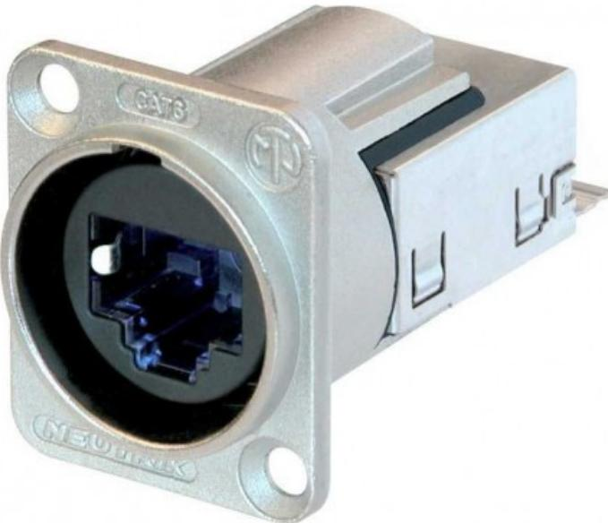
I connettori da pannello etherCON CAT6 a forma di D con alloggiamento in metallo e sistema di bloccaggio sicuro offrono una terminazione IDC senza attrezzi e a tenuta di gas, che rende l'assemblaggio dei cavi facile e veloce. Attenzione! Si abbina solo ai connettori NE8MC6-MO, NKE6S-\* e ai connettori RJ45 generici, non è compatibile con i portacavi NE8MC\*, NE8MX\* etherCON e con i connettori per cavi CAT6 NE8MX6\*.
