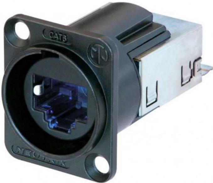
I connettori da pannello etherCON CAT6 Form D con alloggiamento in metallo nero e sistema di bloccaggio sicuro offrono una terminazione IDC a tenuta di gas e senza attrezzi, rendendo l'assemblaggio dei cavi più semplice e veloce. Attenzione! Si abbina SOLO ai connettori NE8MC6-MO, NKE6S-\* e ai connettori RJ45 generici e non è compatibile con i portacavi NE8MC\*, NE8MX\* etherCON e con i connettori per cavi CAT6 NE8MX6\*.
