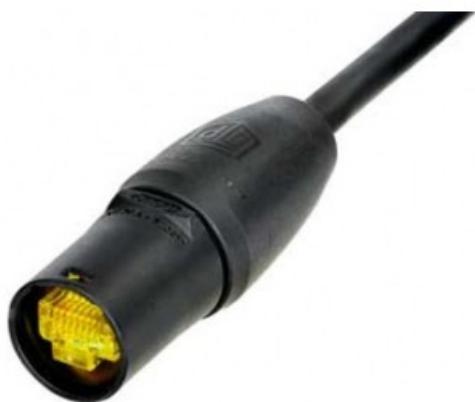
Il connettore per cavi è composto da una custodia cromata nera, un morsetto e una protezione. La protezione è adatta per cavi di diametro compreso tra 5 e 8 mm. Solo per cavi non preassemblati. Il connettore per cavi non include una spina RJ45. Grado di protezione IP65 e approvazione TOP in base alla norma UL50E se accoppiato con il connettore per cavo o il telaio corrispondente della gamma TOP XLR. ATTENZIONE: non compatibile con i connettori a telaio CAT6 NE8FDY-C6 e NE8FDY-C6-B.
