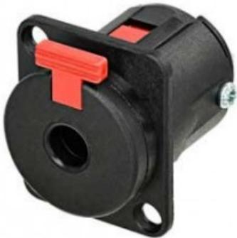
La versione a 3 poli per montaggio a pannello della presa telefonica garantisce connessioni stabili e sicure in caso di disconnessione accidentale o di urti e vibrazioni. Si aggancia a spine standard mono o stereo di calibro A. La spina si blocca automaticamente quando è inserita e si sblocca solo premendo la linguetta rossa di rilascio. Aspetto standard di dimensione D sul pannello frontale. Opzioni di messa a terra selezionabili.
