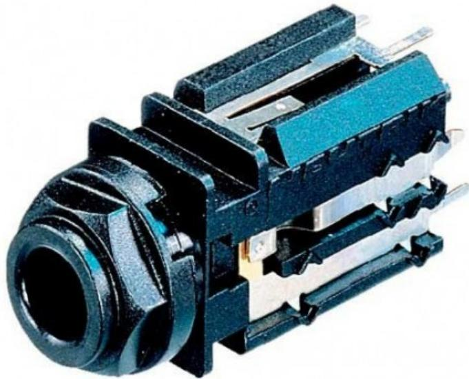
2 x spina jack stereo di commutazione (normalizzazione) (T/TN/R/RN/S)Connettore da pannello verticale montato su PCB in versione A con contatti placcati in oro ed esclusivo tappo a fissaggio rapido per un rapido montaggio a pannello. La separazione tra la chiusura meccanica e i contatti elettrici offre un'elevata forza di ritenzione combinata con una bassa forza di inserimento.
