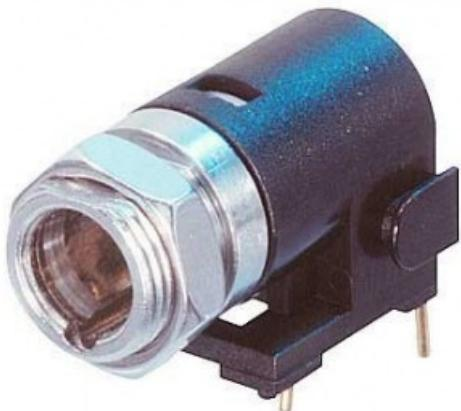
Connettore a telaio maschio a 3 pin, montaggio orizzontale su PCII nanoCON è il connettore a 3 poli con chiusura più piccolo al mondo. Offre un robusto alloggiamento in metallo, un dispositivo di bloccaggio in metallo, contatti placcati in oro e un'eccellente ritenzione del cavo.
