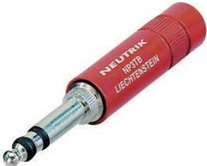
Connettore telefonico professionale da 1/4 conforme allo standard B-Gauge BPO316. La costruzione è simile a quella dei connettori telefonici Neutrik standard, con scarico della trazione a mandrino e un sottile cilindro metallico. Questi connettori non sono compatibili con i jack standard da 1/4 (secondo EIA RS453) o con i pannelli patch.
