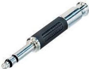
Connettore telefonico miniaturizzato di tipo bantam da 4,4 mm (0,173 ), terminazione a saldare per T + R, terminazione a crimpare per S, scarico della trazione del filo con crimpatura esagonale, corpo in plastica nera, contatti in nichel. Ideale per l'uso con i pannelli patch TT.
