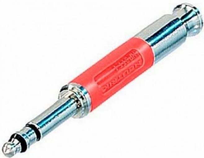
Piccolo connettore telefonico di tipo bantam da 4,4 mm (0,173 ), terminazione a saldare per T+ R, terminazione a crimpare per S, scarico della trazione del filo a crimpare esagonale, alloggiamento in plastica rossa, contatti in nichel. Ideale per l'uso con i pannelli patch TT.
