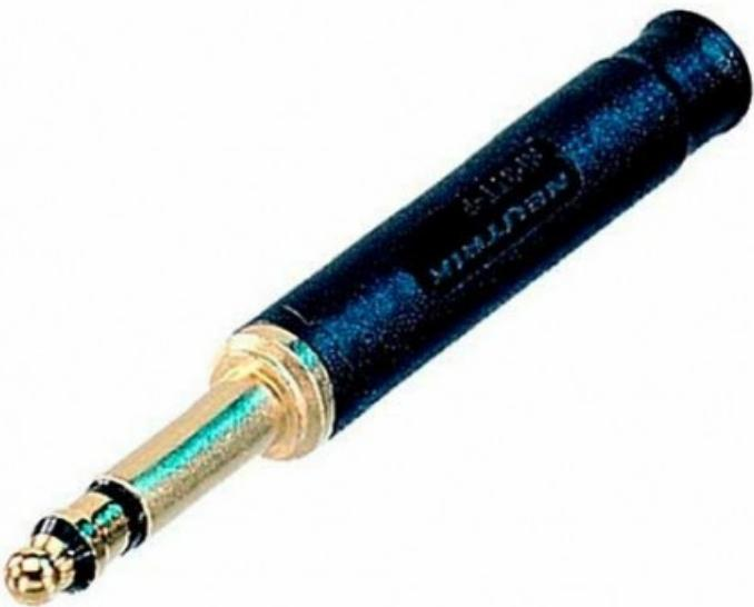
Spina telefonica piccola di tipo bantam da 4,4 mm (0,173 ), terminazione a saldare per T+R, crimpatura esagonale S con pinza di crimpatura standard RG58, alloggiamento in plastica nera, contatti dorati. Ideale per l'uso con i pannelli patch TT.
