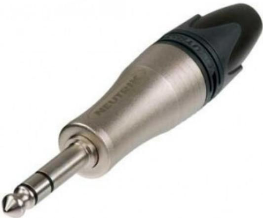
Spina telefonica professionale a 3 poli da 1/4", per cavi con diametro esterno fino a 10 mm. Il connettore jumboPLUG professionale da 1/4" per cavi spessi per strumenti e altoparlanti offre un corpo ergonomico e incorpora le caratteristiche e i vantaggi collaudati della gamma PX standard.
