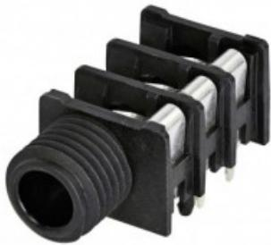
Connettore stereo da 1/4 , senza interruttore, filettatura completa all'estremità, connessione al pannello frontale/contatto con la manica. Connettore orizzontale per montaggio a pannello su PCB che offre un'elevata densità di confezionamento sulla scheda se montato su centri minimi di 15,88 mm (0,625 pollici) in file o array. L'hardware di montaggio deve essere ordinato separatamente.
