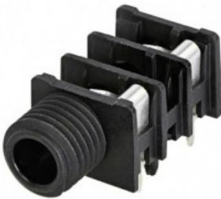
Connettore jack mono da 1/4 , con interruttore e naso completamente filettato. Connettore orizzontale per montaggio a pannello su PCB, caratterizzato da un'elevata densità di confezionamento sulla scheda se montato su interassi minimi di 15,88 mm (0,625 ) in file o array. L'hardware di montaggio deve essere ordinato separatamente.
