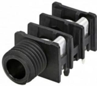
Connettore jack mono da 1/4 , con interruttore, punta completamente filettata, manicotto/contatto sul pannello frontale. Connettore orizzontale per montaggio a pannello su PCB che offre un'elevata densità di confezionamento sulla scheda quando viene montato su interassi minimi di 15,88 mm (0,625 pollici) in file o array. L'hardware di montaggio deve essere ordinato separatamente.
