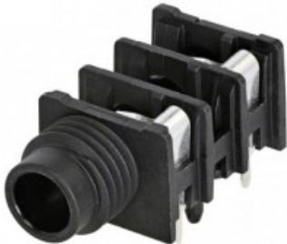
Connettore jack mono da 1/4 , con interruttore, punta mezza filettata. Il connettore orizzontale per montaggio a pannello su PCB consente di ottenere un'elevata densità di confezionamento sulla scheda se montato su interassi minimi di 15,88 mm (0,625 ) in file o array. L'hardware di montaggio deve essere ordinato separatamente.
