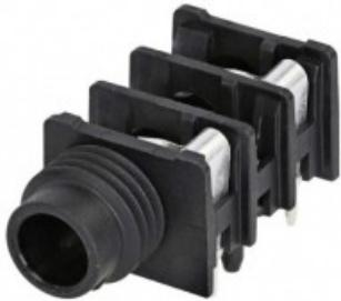
Connettore jack mono da 1/4 , con interruttore, punta a mezza filettatura, manicotto/contatto sul pannello frontale. Connettore orizzontale per montaggio a pannello su PCB che offre un'elevata densità di confezionamento sulla scheda se montato su interassi minimi di 15,88 mm (0,625 pollici) in file o array. L'hardware di montaggio deve essere ordinato separatamente.
