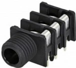
Connettore jack stereo da 1/4 , con interruttore e filettature completamente filettate. Il connettore orizzontale per il montaggio a pannello su PCB offre un'elevata densità di confezionamento sulla scheda se montato su interassi minimi di 15,88 mm (0,625 ) in file o array. L'hardware di montaggio deve essere ordinato separatamente.
