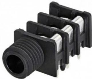
Connettore jack stereo da 1/4 , commutabile, filettatura completa in punta, connessione al pannello frontale tramite contatto a manicotto. Connettore orizzontale per montaggio a pannello su PCB che offre un'elevata densità di confezionamento sulla scheda quando viene montato su interassi minimi di 15,88 mm (0,625 pollici) in file o array. L'hardware di montaggio deve essere ordinato separatamente.
