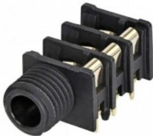
Connettore stereo da 1/4 , commutato, contatti placcati in oro, filettatura completa in punta, connessione pannello frontale/contatti a manicotto. Connettore per montaggio a pannello orizzontale su PCB che offre un'elevata densità di confezionamento su scheda se montato su centri minimi di 15,88 mm (0,625 pollici) in file o array. L'hardware di montaggio deve essere ordinato separatamente.
