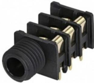
Connettore stereo da 1/4 , con interruttore, contatti placcati oro, punta completamente filettata. Connettore orizzontale per montaggio a pannello su PCB che offre un'elevata densità di confezionamento sulla scheda quando viene montato su interassi minimi di 15,88 mm (0,625 pollici) in file o array. L'hardware di montaggio deve essere ordinato separatamente.
