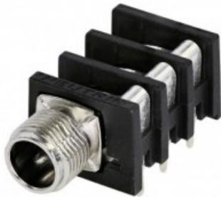
Connettore stereo da 1/4 , con alloggiamento in metallo e messa a terra efficiente del telaio, contatto di standardizzazione T+R+S. Il connettore orizzontale per montaggio a pannello su PCB offre un'elevata densità di confezionamento sulla scheda se montato su centri minimi di 15,88 mm (0,625 pollici) in file o array. L'hardware di montaggio deve essere ordinato separatamente.
