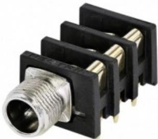
Connettore stereo da 1/4 , con alloggiamento in metallo, contatti placcati in oro, messa a terra efficiente del telaio, contatto di standardizzazione T+R+S. Connettore montato orizzontalmente su pannello PCB che offre un'elevata densità di confezionamento su scheda se montato su centri minimi di 15,88 mm (0,625 pollici) in file o array. L'hardware di montaggio deve essere ordinato separatamente.
