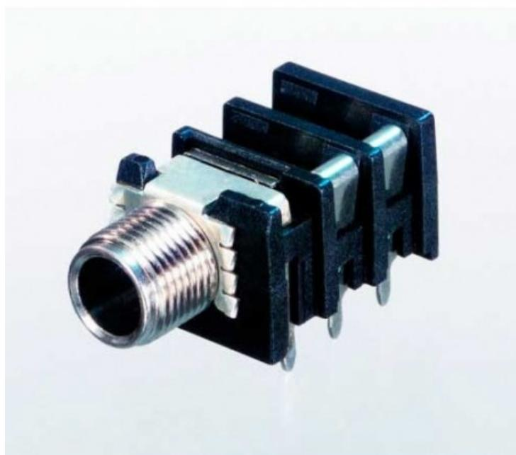
Connettore stereo da 1/4 , con punta metallica, efficiente messa a terra del telaio, contatto di standardizzazione T+R. Il connettore orizzontale per montaggio a pannello su PCB offre un'elevata densità di confezionamento sulla scheda se montato su centri minimi di 15,88 mm (0,625 pollici) in file o array. L'hardware di montaggio deve essere ordinato separatamente.
