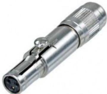
Connettore per cavi femmina a 3 poli con dispositivo antistrappo a mandrino e contatti a saldare.nanoCON è il più piccolo connettore di bloccaggio a 3 poli al mondo. Offre un robusto alloggiamento in metallo, un dispositivo di bloccaggio in metallo, contatti placcati in oro e un'eccellente ritenzione del cavo.
