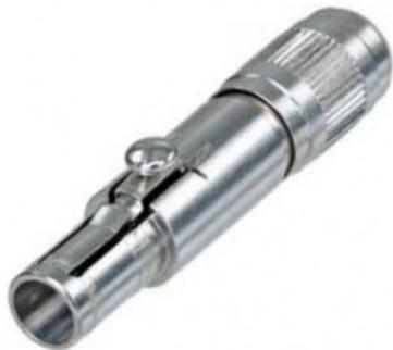
Connettore per cavi maschio a 3 poli, tipo di bloccaggio a mandrino e contatti a saldare.nanoCON è il connettore a 3 poli bloccabile più piccolo al mondo. Offre un robusto alloggiamento in metallo, un dispositivo di bloccaggio in metallo, contatti placcati in oro e un'eccellente ritenzione del cavo.
